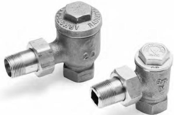
Estas trampas son ideales para drenar el condensado de equipos tales como radiadores y convectores, pequeños intercambiadores de calor, y calentadores de aire unitarios. Así mismo, pueden utilizarse como eliminadores de aire y gases no condensables. Las trampas TS-2 vienen con un robusto cuerpo en bronce fundido y asiento en acero inoxidable. Tanto la válvula como el asiento se pueden reemplazar en línea.
